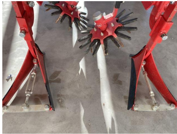
Foto 1. Radrenser monteret med henholdsvis plader (tv.) og fingerhjul og hyppeskær.
