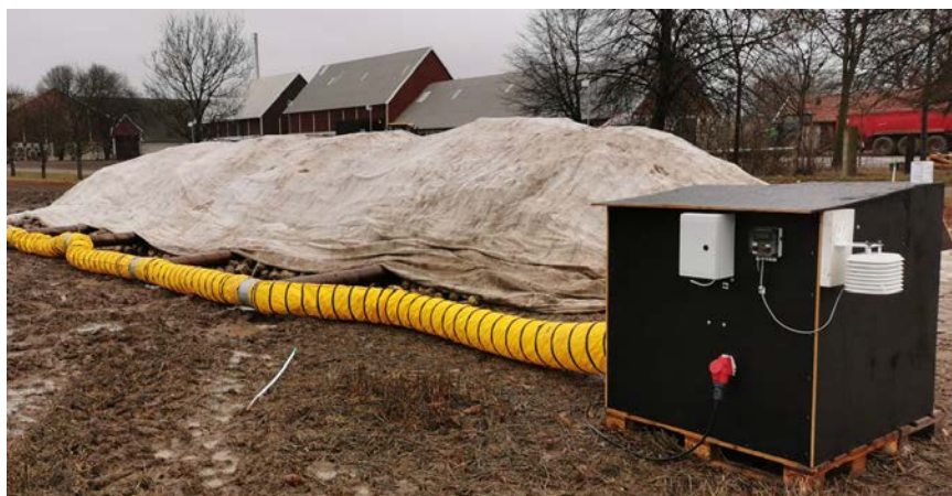
Figur 4. Fläktenhet installerad i en betstuka. I toppen av stukan syns temperaturspjuten.
