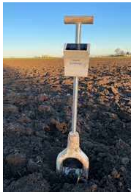
Jordanalysinstrumentet med spadlika drag. Med det digitala tyska mätinstrumentet Stenon FarmLab flyttas laboratoriet ut i fält.
