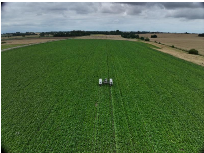
Foto 1. Dataindsamling i sukkerroer med markrobot. RGB-kamera monteret på 3-punktsophæng.
