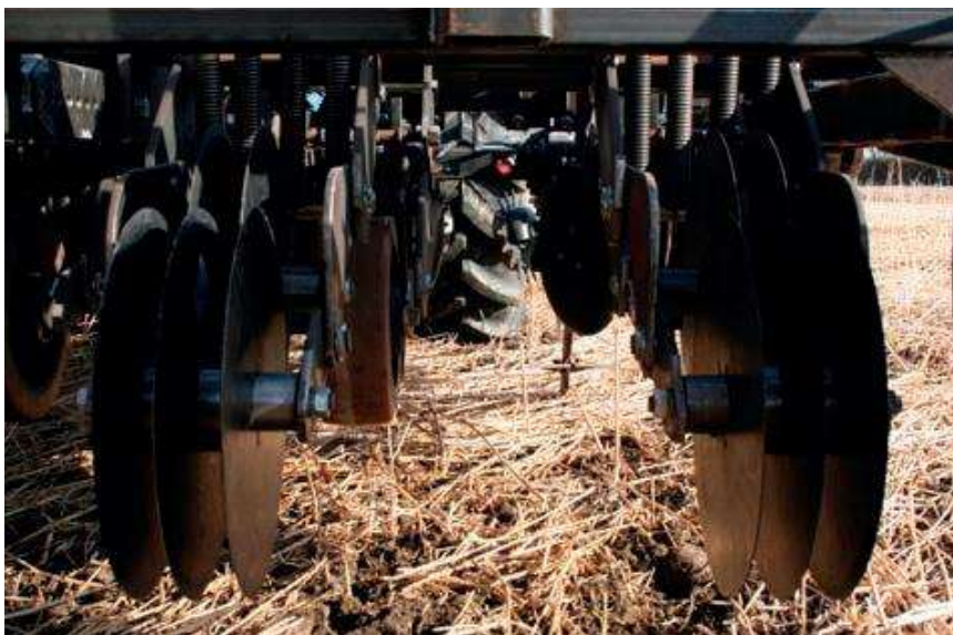
Foto 5. Diverse forsøg på at skabe et godt såbed omfattede også en enhed bestående af fem metalskiver til at findele jorden. Sikkert en udmærket idé på sandjord, men svært at få til at fungere på lerjord. Bemærk tanden forrest, som havde til formål at løsne jorden under roerækken.
