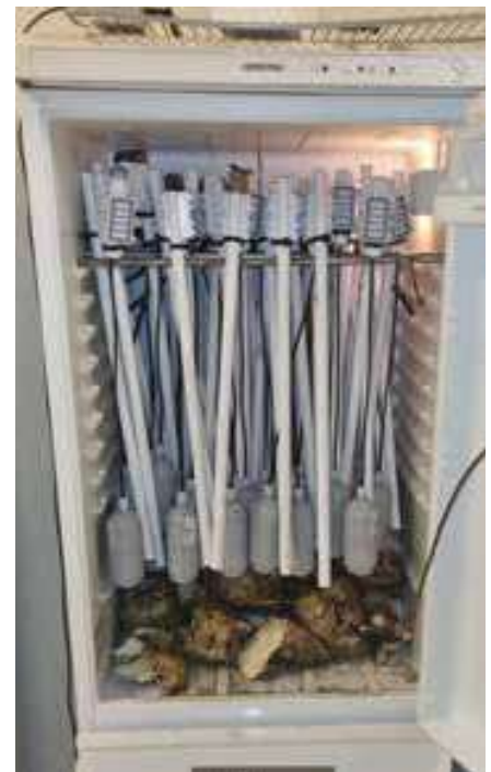
Kalibrering på gång. För att veta att alla mätare rätt kalibreras koldioxidmätarna med en standardiserad modell.
