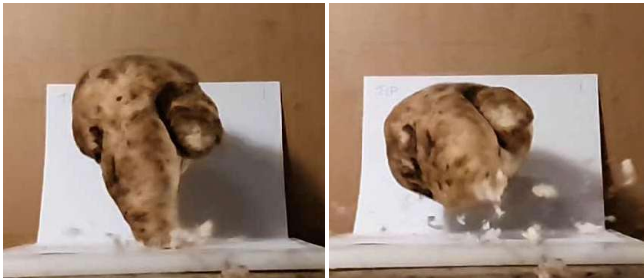
Betans hållfasthet. Här foto på hur betan skadas i falltest som vi gör i samarbete med SLU Alnarp.
