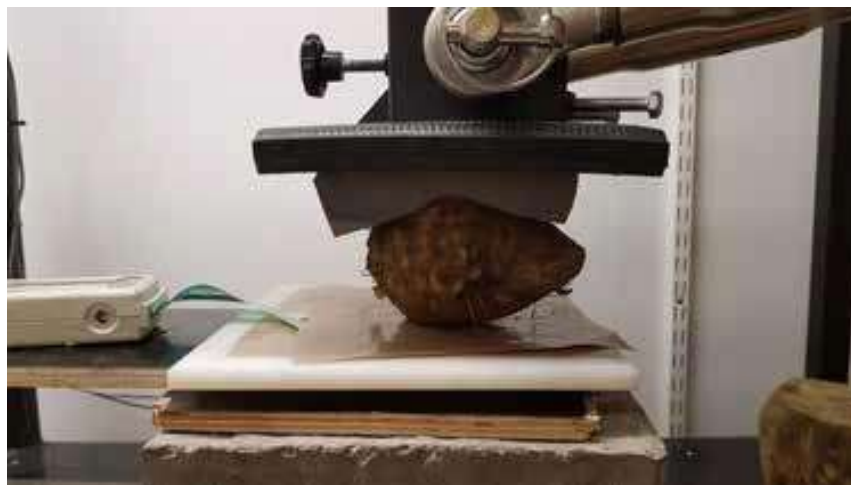
Kompressionstest av betor. Utförd vid SLU Alnarp som en del av ett examensarbete.
