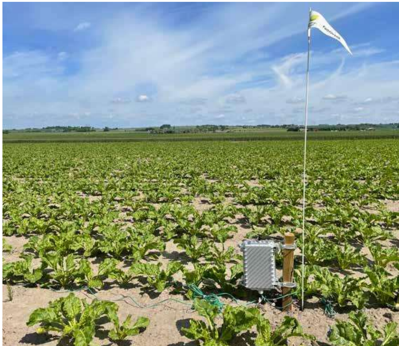
Boxen i fält. Här samlas uppgifter in från de tre markfuktsensorerna och skickar resultaten i realtid vidare ut bland datamolnen.
