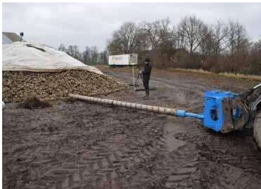
Rören monteras. I betor skruvas rören in med en modifierad dukrullare från Edenhall. I stärkelsepotatis kan rören tryckas in med pallgafflar.
