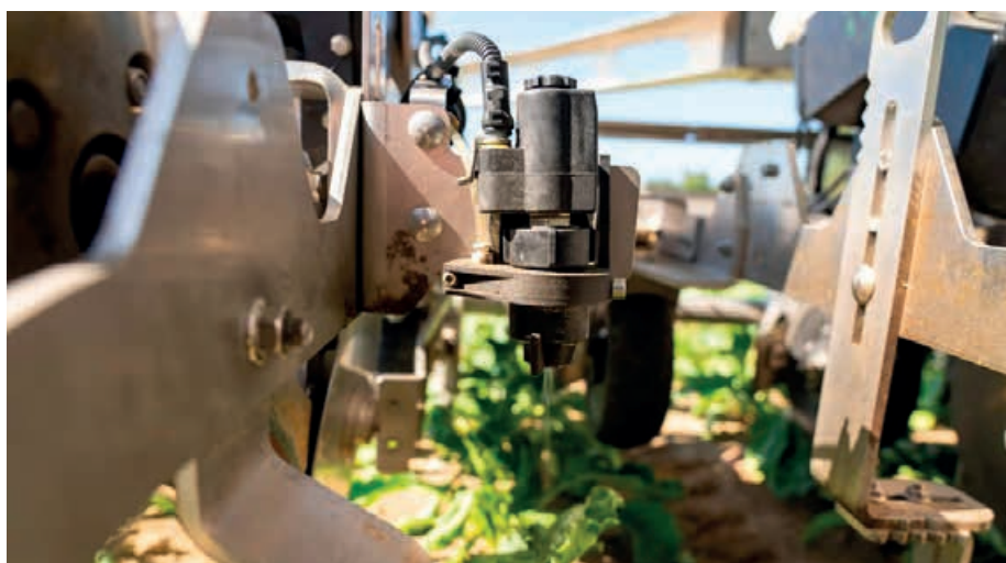
Foto 1-2. Farmdroids doseringssystem består af en enkelt dyse placeret over roerækken (tv.). Ved hjælp af GPS-lokalisering af den enkelte roeplante er det muligt at begrænse den kemiske bekæmpelse til et lille område omkring roen (th.). Der anvendes pulserende dyser for at nedbringe væskemængden i det behandlede område til et passende niveau. Fotos: Farmdroid og NBR
